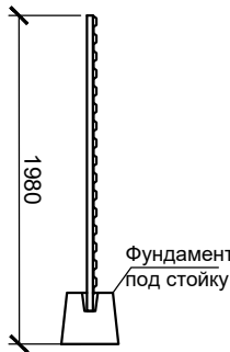
Деталь устройства временного ограждения без козырька
